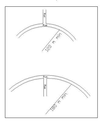
Il ne doit pas y avoir de courbe de rayon intérieur inférieur à 90 mètres à moins de 30 mètres d'une intersection.
