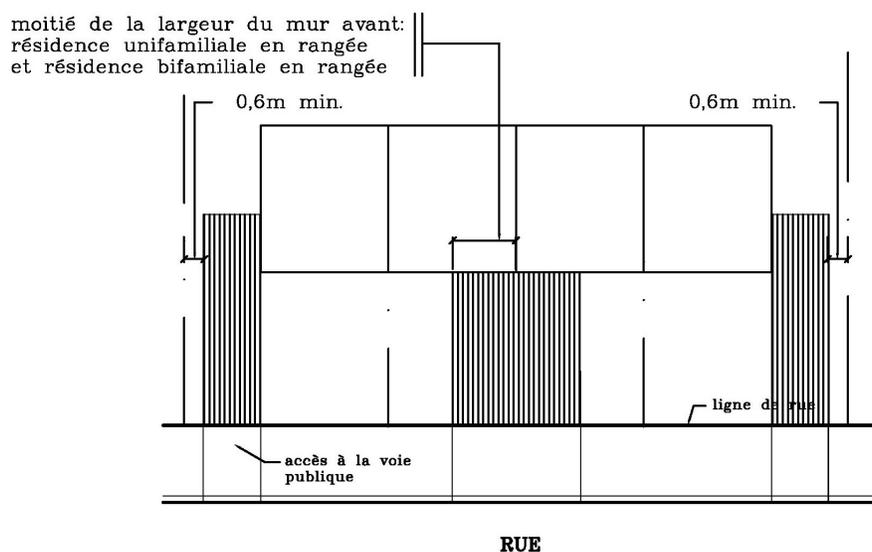
**Figure 6 : Normes d'implantation et dimensions d'une aire de stationnement pour les bâtiments de 3 logements et plus, habitations communautaires ou en commun**
